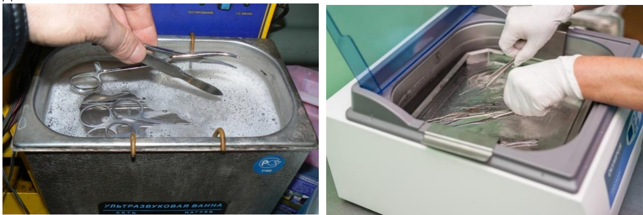
Рис. 1.3. Обработка инструментария в ультразвуковой ванне ( http://www.matrixplus.ru/ultramedster.htm )
